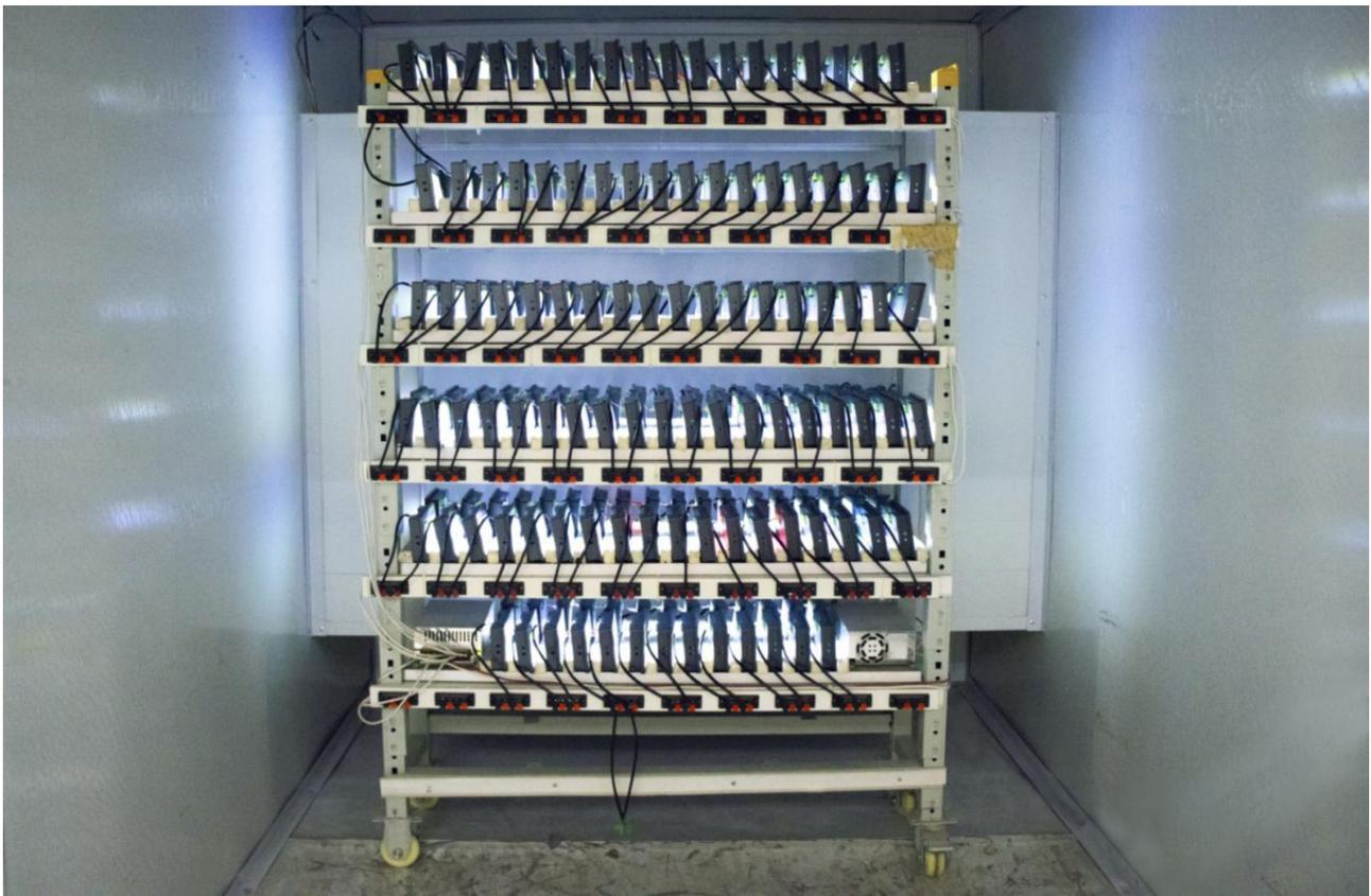
测试环境:高低温老化测试箱中
