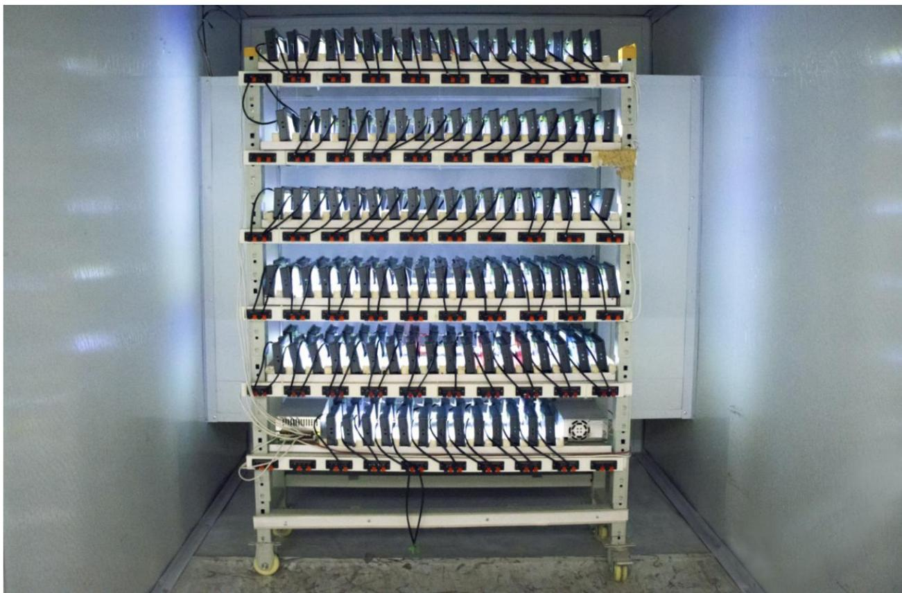
测试环境:高低温老化测试箱中
